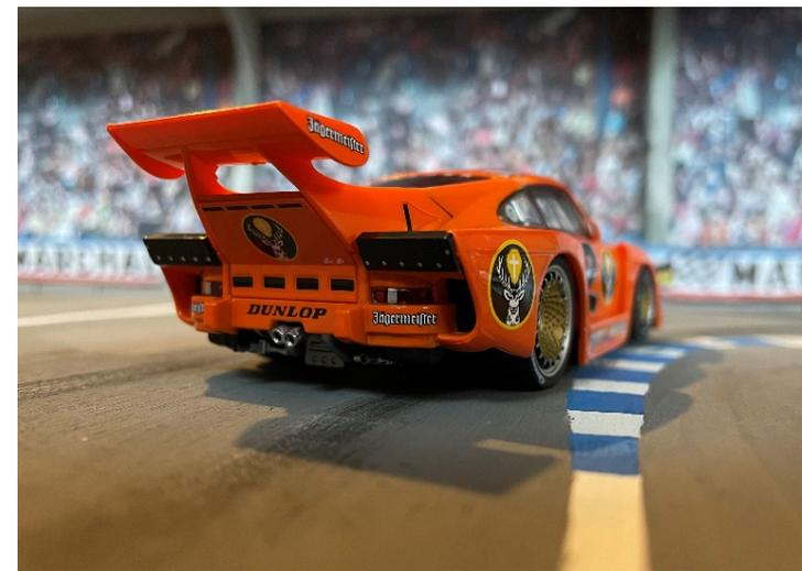
Über zwei mittige Rohre atmet der Turbo aufgeladene 935er aus seinen Brennräumen. Beim Herunterschalten züngeln Flammen aus dem Heck. Typisch für Turbos aus dieser Ära. Die BBS Räder sind mit nach innen gewölbten Scheiben verkleidet. Einerseits begünstigen sie die Aerodynamik. Zugleich bringen sie nötige kühlende Luft zu den Scheibenbremsen.
