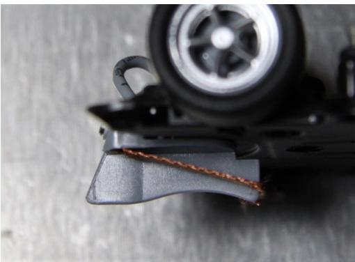
**Hohlkammerfelgen mit Luftpolster für mehr Grip. Geschwungener L-Kiel für maximalen Halt. Weder Side- noch Anglewinder: Mach 21 OS Motor sitzt wenige Grad schräg vor der Stahlachse. Das Fahrwerk ist über drei Schrauben einstellbar. Die Vorderachs-Höhe auch. Platz für Trimmblei wäre vorhanden. Wir fahren ihn pur mit 12 Voltan im Tank, sind damit vollauf zufrieden und kommen sehr gut mit dem Boliden zurecht. Er liegt sehr satt und hat jederzeit Druck für Angriffe im Rennen.**
