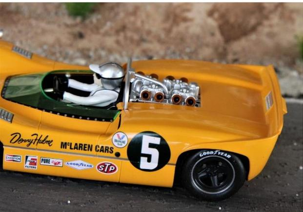
Der blaue M8B saugt seine Luft über senkrecht stehende Trichter an, die mit einer Hutze versehen sind. Sie lenkt den Fahrwind um. Der M6A in Orange saugt die Luft seitlich durch offene Trichter an. Beide Cockpits werden im Ernstfall durch Überrollbügel abgesichert. Die Fahrer im Jethelm sitzen fast offen wie in einem Kart. Eine dezente Scheibe lenkt die Luft um.
