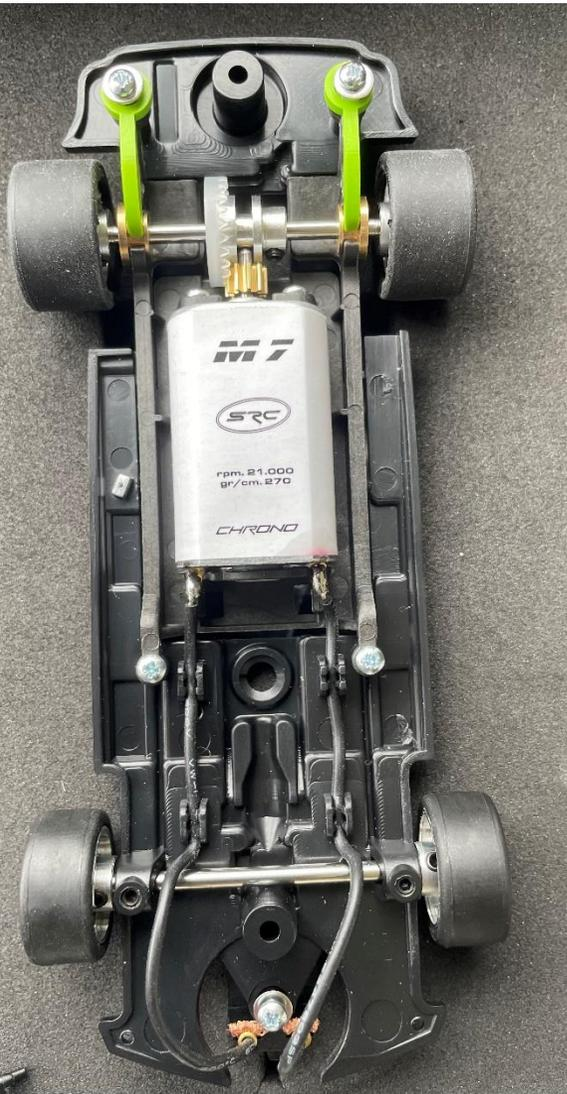
Inliner Konzept mit Longcan Aggregat: 21000 Touren maximal und 270g/cm Drehmoment wuchten den BMW nach vorne. Das Fahrwerk ist komplett einstellbar, die Komponenten hochwertig und verschraubt. Alles passt perfekt.
