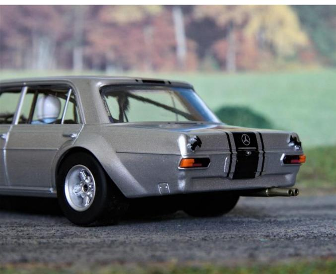
Sinnlich, kantiges Blech, ausgestellte Kotflügel für breite Slicks. Der SEL braucht sie zum Räubern auf der Ideallinie. Lautstark souverän wummert das 6.3 Liter Aggregat aus dem doppelläufigen Endrohr, das optimistisch übersteht. Haubenschnellverschlüsse für zügige Wartungsarbeiten. Den Fahrer schützt ein eingeschweißter Käfig, sollte er den Wahnsinn unter dem Helm ausreizen. Das Shining ist silber, sehr gelungen mit Schwarz. Auch bei leichtem Morgendunst an der Strecke.
