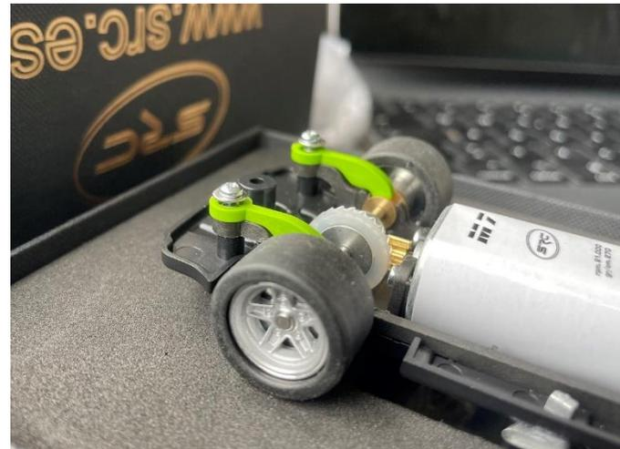
Vom Hauptchassis entkoppelter Antriebsstrang für eine satte Straßenlage, auch am Limit der Physik.
