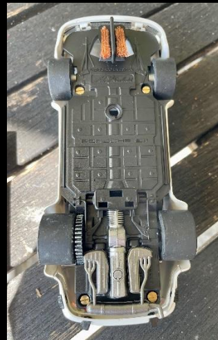
Überstände abfeilen und Löcher dezent weiten, die Karosserie kann mit gelösten Schrauben in Kurven entkoppelt arbeiten.
